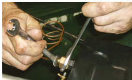
Immer schön gegenhalten, sonst bricht die Leitung des Fernthermometers ab
