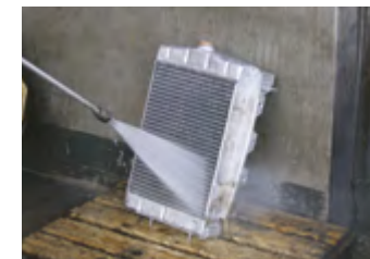
Mit Hochdruck werden die letzten Flussmittelreste weggeblasen
