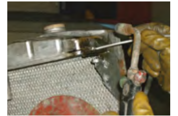
Dann folgen die Halter für die Befestigungsstreben
