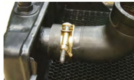
Baumarkt, nein danke: So muss eine Schlauchschelle am Vorkriegsauto aussehen!
