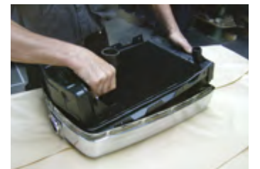
Sobald der Speziallack trocken ist, kommt die Maske drüber
