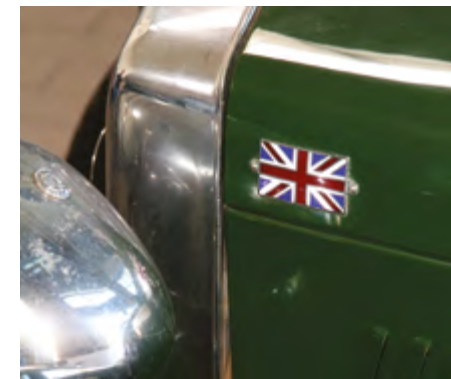
Dank eines lausig eingepassten Kühlers sitzt auch die Motorhaube unseres MG J2 schlecht
