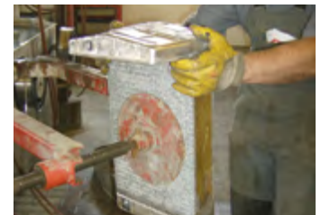
Bevor der obere Kasten verlötet wird, richtet er ihn exakt aus
