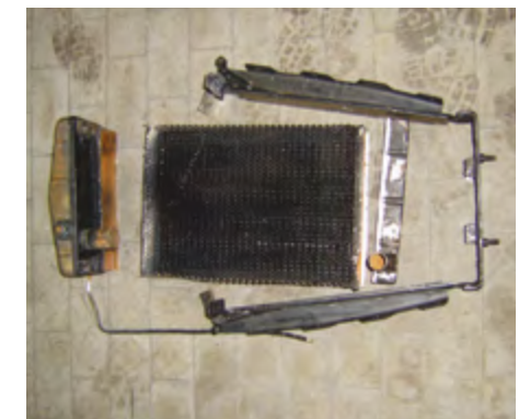
Separiert: Die beiden Wasserkästen, das Netz und der Trägerrahmen gehen getrennte Wege
