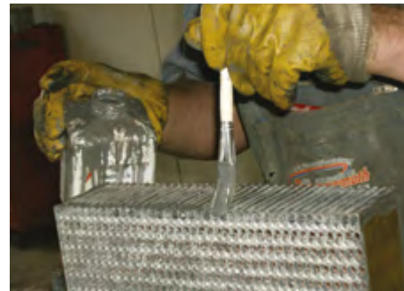
Echt ätzend: Säurehaltiges Flussmittel sorgt für eine haltbare Lötverbindung
