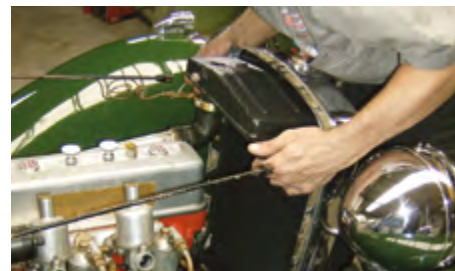
Vorsichtig setzt der Spezialist den verkleideten Kühler wieder ins Auto
