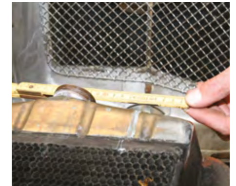
Der Kühlerbauer notiert alle Ursprungsmaße, damit er später korrigieren und anpassen kann
