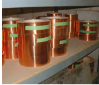
Unser Wabenkühler wird aus solchen Kupferblechstreifen gemacht
