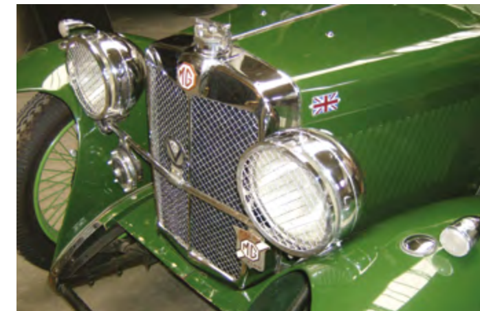
Passt perfekt: Das Spaltmaß ist rundherum gleichmäßig
