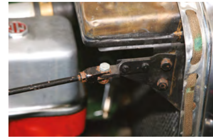
Dank eines lausig eingepassten Kühlers sitzt auch die Motorhaube unseres MG J2 schlecht
