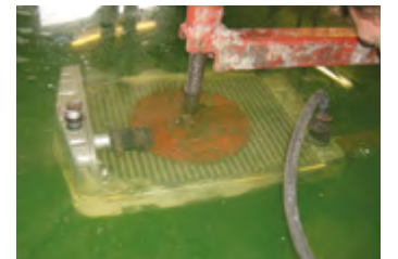
Ganz dicht? Mit einem Bar Druck erfolgt die Kontrolle unter Wasser
