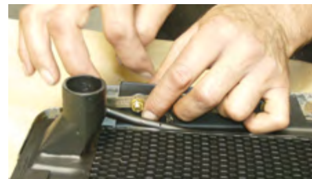
Mit originalgetreuen Messingschrauben wird die Maske nun am Rahmen befestigt
