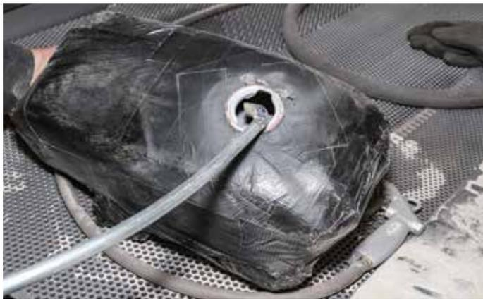
Nach mehrstündigem Durchlüften mit Druckluft ist die feuchte Masse am Tankboden abgetrocknet. Rückstände verschwinden beim Glasperlstrahlen
