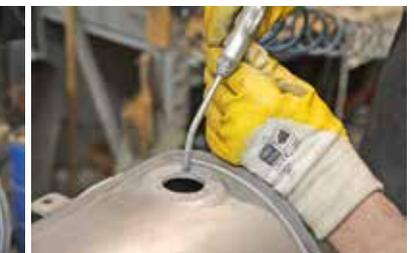
Wo der Stopfen saß, wird mit dem Pinsel nachgearbeitet. Ein kurzer Druckluftstoß reinigt die Gewindebohrungen für den Füllstandsanzeiger
