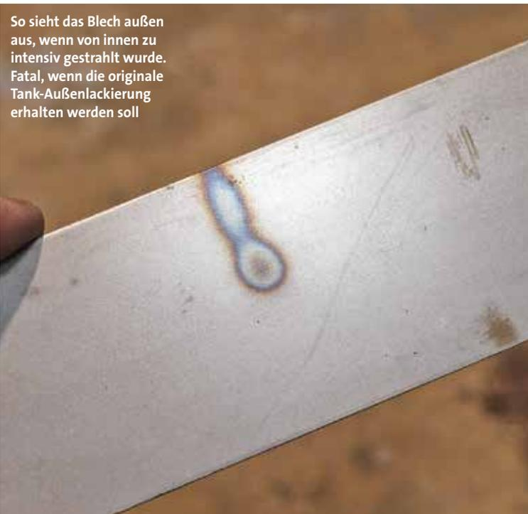
So sieht das Blech außen aus, wenn von innen zu intensiv gestrahlt wurde. Fatal, wenn die originale Tank-Außenlackierung erhalten werden soll
