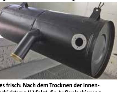
Alles frisch: Nach dem Trocknen der Innenbeschichtung (I.) folgt die Außenlackierung
