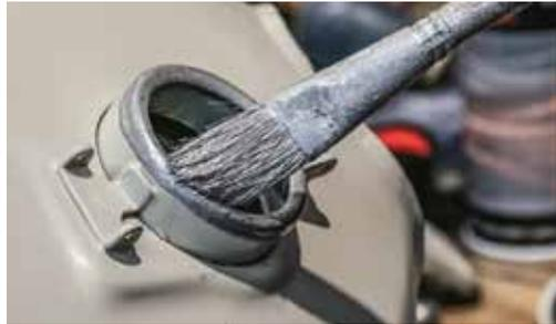
Nach dem Ablassen des überschüssigen Mittels zeigt sich, dass nur sehr wenig im Tank verblieben ist. Auch den Einfüllstutzen behandelt der Profi, damit die Schicht nicht von außen unterwandert wird
