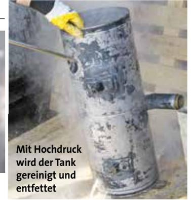
Mit Hochdruck wird der Tank gereinigt und entfettet
