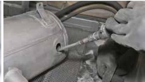
Nach der Reinigung bleibt Oberflächenrost übrig. Der Profi entfernt die Korrosion per Glasperlstrahlen, wobei er mit Eigenbau-Mundstücken jeden Winkel erreicht
