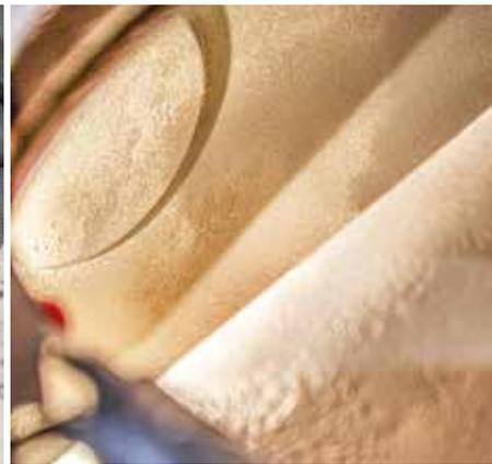
Nach dem Strahlen ist der Mofatank bereit zum Versiegeln. Die Sanierungskosten: rund 200 Euro
