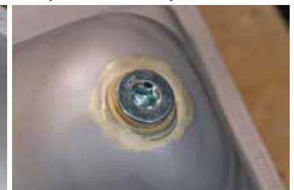
Die Gewindebuchse M22 x 1,5 passt genau in die Öffnung. Sie ist für den besonderen Zweck modifiziert. Drei Bohrungen im Gewinde sorgen dafür, dass nun nicht die Buchse den Abfluss behindert. Schließlich wird die Buchse mit Hartlot in der Öffnung fixiert und kann mit einem Schraubstopfen verschlossen werden
