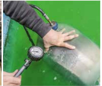
Links die makellose Optik nach dem Glasperlenbeschuss. Für den Drucktest auf Dichtheit im Wasserbecken montiert der Profi eine Blechstrebe. Sonst bestünde die Gefahr, dass sich die Seiten auseinanderbiegen
