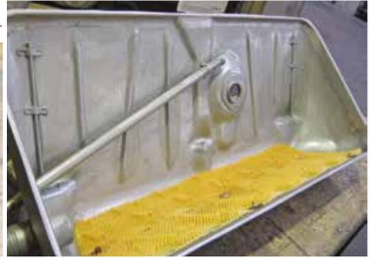
Dieser Benzintank eines 107er-Mercedes musste an der Schweißnaht aufgesägt werden, da sich in seinem Innern nicht nur Röhrchen befinden, sondern auch Kunststoffteile, die eine Versiegelung unmöglich machen, wenn sie an Ort und Stelle bleiben
