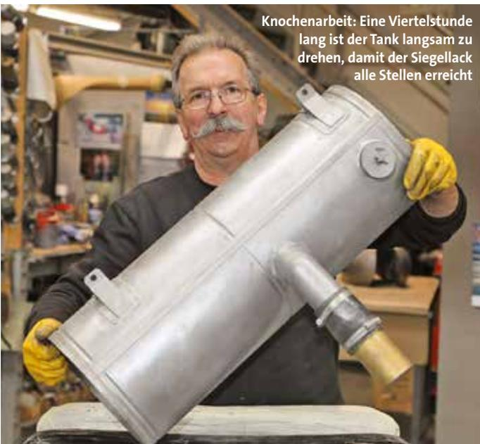
Knochenarbeit: Eine Viertelstunde lang ist der Tank langsam zu drehen, damit der Siegellack alle Stellen erreicht
