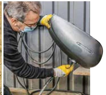
Die Bestandsaufnahme ergibt kleinere Dellen, die vor dem Versiegeln entfernt werden müssen. Auf das Wasserstrahlen folgt die Hochdruckspülung mit entfettendem Reinigungsmittel. Nach dem Trockenblasen mit Druckluft kommt der Tank für einige Zeit zum gründlichen Austrocknen in den Heizöfen
