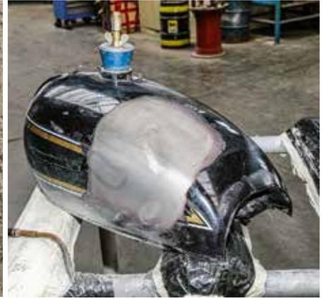
Im Bereich der Delle überlebte die innere Schutzschicht tatsächlich, jedoch entdeckte Experte Roland Bockisch an anderer Stelle Ungemach: Die Altversiegelung hat Risse an der Fuge zwischen Boden und Seitenwand und sollte komplett entfernt werden. Dazu muss der Tank mit Lösemittel gefüllt zwei Wochen stehen
