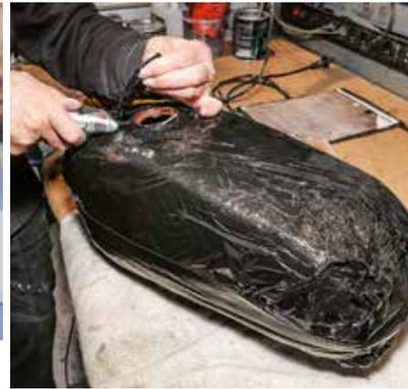
Über lange Jahre eingedickter Sprit und Rost im Zündapp-Mofatank: Zum Schutz der Originallackierung wird eine lückenlose Panzerung mit Papier, Kleband und vielen Lagen elastischer Verpackungsfolie hergestellt
