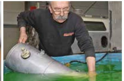
Glasmehl und Strahlstaub müssen akribisch abgesaugt werden. Dann werden alle Öffnungen mit Stopfen verschlossen und es geht mit minimalem Überdruck in die Badewanne zur Dichtheitsprüfung
