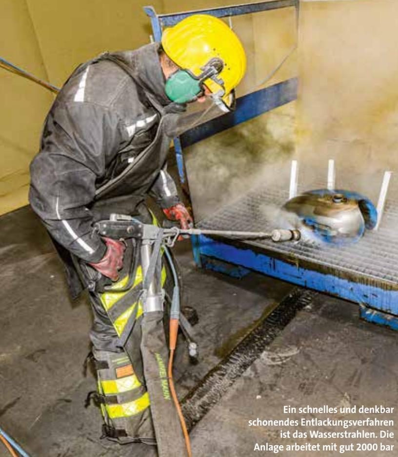
Ein schnelles und denkbar schonendes Entlackungsverfahren ist das Wasserstrahlen. Die Anlage arbeitet mit gut 2000 bar
