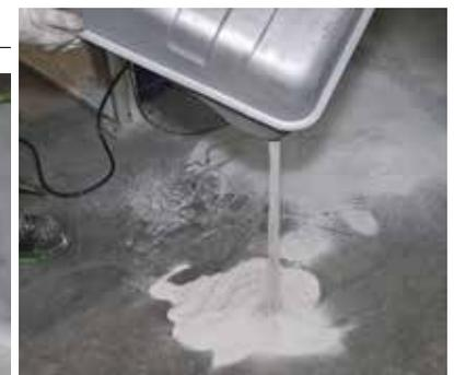
Bei diesem Mercedes-G-Tank ist das Problem der nach innen ragende Füllstutzen, der die völlige Entleerung von Strahlmittel und überschüssigem Siegelack verhindert. Deshalb bohrt Roland Bockisch ein 30-Millimeter-Loch zum späteren Einsetzen einer Gewindebuchse. Die Glasperlen können komplett herausrieseln
