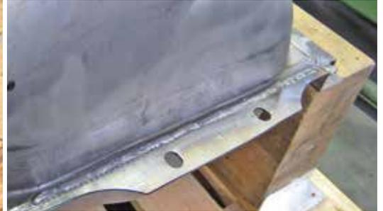
Die Versiegelung wird aufgepinselt, wobei ein Streifen für die spätere Schweißnaht frei bleibt und die Randzone angeschliffen wird. Dann kommen Dämmmatte und Rückhaltebecher aus Plastik wieder an Ort und Stelle, und die Hälften werden verschweißt
