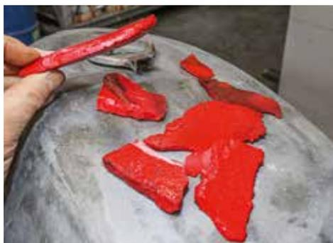
Zentimeterdicke Fragmente einer 1K-Epoxy-Versiegelung aus dem Tank einer BMW R90 S
