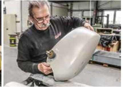
Trockenblasen und kurz in den Heizofen, dann folgt die Epoxy-Grundierung, hier nur zur Anschauung schon vor der Versiegelung, sonst erst nachher
