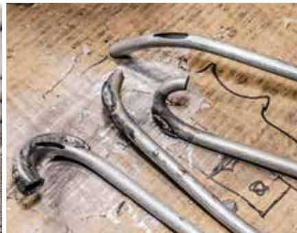
Mittels LötKolben und Zinn verschwindet die letzte Unebenheit. Überstehendes Material nimmt der Karosseriehebel ab. Danach geht es in die Strahlkabine. Die speziell gebogenen Mundstücke sind schon nach kurzer Zeit löchrig
