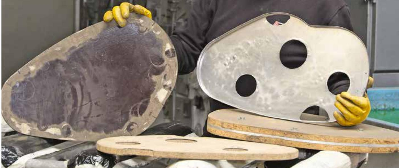
Die Entfernung der rissigen Altbeschichtung des Honda-Tanks (siehe Teil 1) hat leider nicht funktioniert. Der Behälter muss ins Bad eines Entlackungs-Profis
