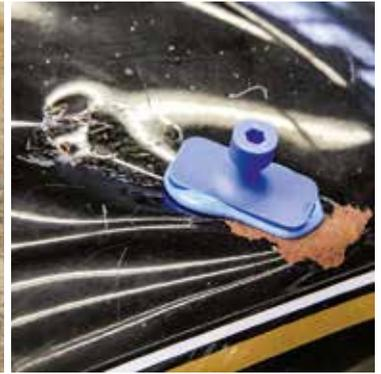
An diesem Honda-Tank probierten wir das Dellenziehen mit Klebepilzen und Gleitgewicht-Ziehhammer (siehe Heft 12/2020), da die Hitze beim Aufschweißen von Zugankern die bereits früher eingebrachte Versiegelung zerstört hätte. Es funktionierte, war aufgrund der Blechstärke allerdings sehr langwierig
