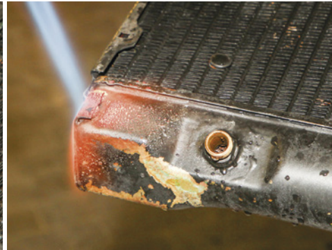
Zunächst entfernt Marco Walther die seitlichen Rahmenteile
