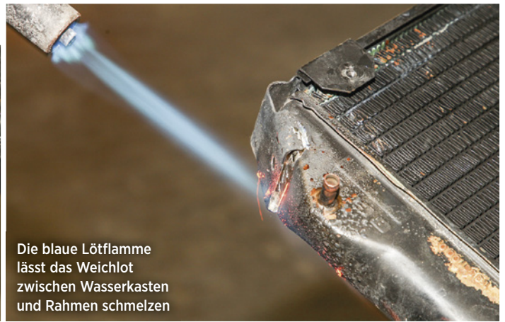
Zunächst entfernt Marco Walther die seitlichen Rahmenteile
