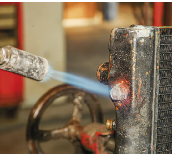
Die Ablassschraube am unteren Wasserkasten wird samt Gewindestutzen ausgelötet
