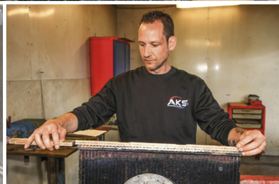
Das alte Netz dient als Vorlage für das Neuteil, das in verschiedenen Maßen lieferbar ist. Bei der Pagode ist es...
