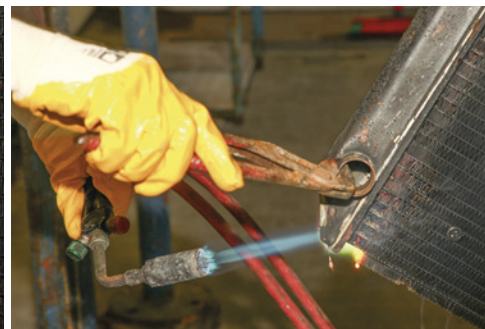
Als letztes Teil wird auch der obere Wasserkasten ausgelötet und beiseite gelegt
