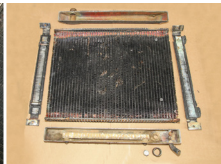
Das alte Netz ist ein Fall für den Schrott, die umgebenden Teile werden aufgearbeitet
