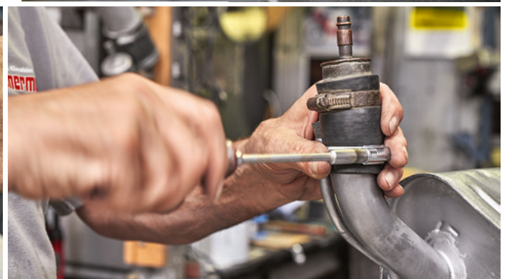
Auf das Füllrohr kommt ein ebenfalls selbstgebautes Schlauchstück mit Luftanschluss, in das Entlüftungsröhrchen ein kleiner Gummistopfen
