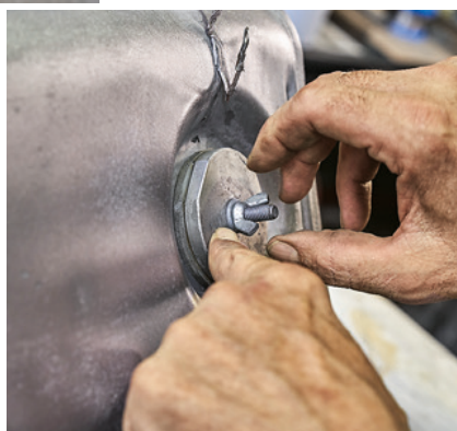
Die Tankgeberöffnung verschließt Bockisch mit einem selbstgebauten Deckel
