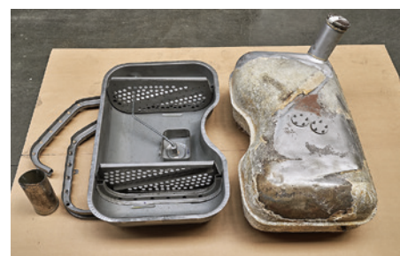
Tank aus den Fünfzigern: Allein die Unterschale besteht aus sieben Bauteilen...
