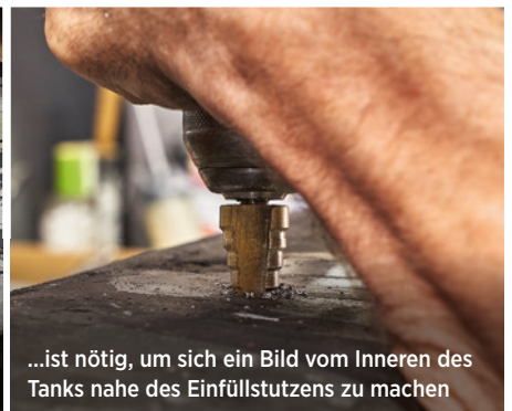
Innen fällt der bis auf kleine Löcher geschlossene Catch-Tank mit Saugleitung auf. Er muss zum Strahlen von außen angebohrt werden
