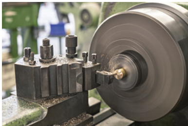
Auf der Drehbank entsteht ein Stopfen für die zu verschließende Bohrung
