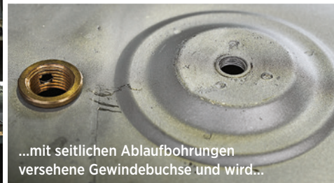
...mit Hartlot eingesetzt, das dank Silberanteil einen niedrigen Schmelz- punkt hat, was Verzug minimiert
