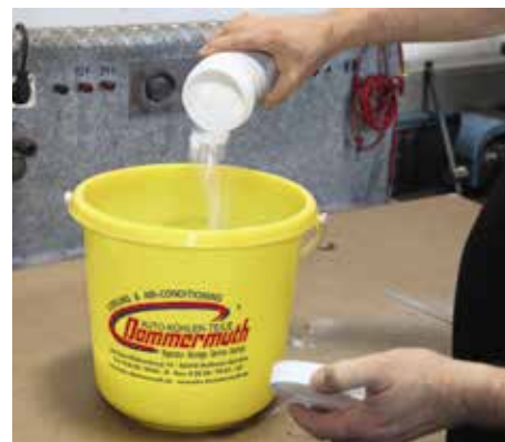
In die gleiche Menge heißen Wassers rührt Rüdiger Dommermuth das granulatformige Entfettungsmittel ein
