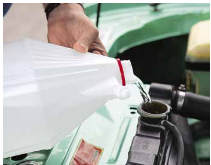
Weiches Regenwasser ist das ideale Kühlmittel. Ebenso wie destilliertes Wasser enthält es kaum Kalk und hat hervorragende Kühleigenschaften
