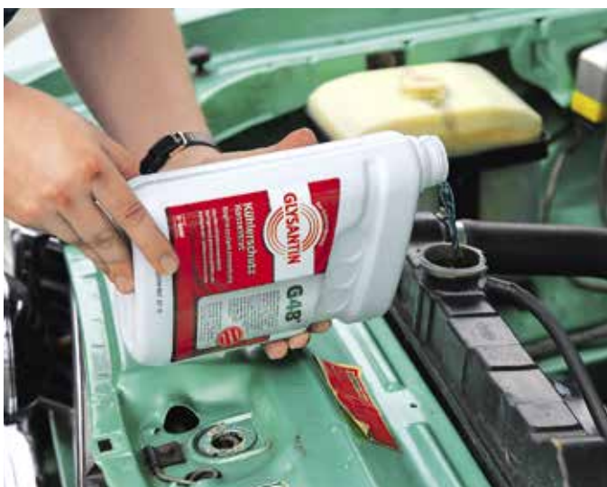
Silikathaltiger Kühlerfrostschutz verhindert nicht nur das Einfrieren, er ist auch ein effektiver Korrosionsschutz und schließt leichte Undichtigkeiten
