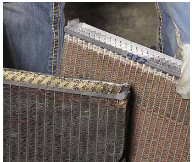
Das Hochleistungsnetz hat nicht nur drei Kühlkanäle hintereinander, die Kanäle rücken auch näher zusammen und sind zahlreicher
