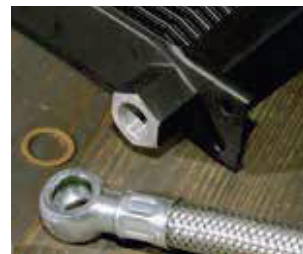
Der Innengewinde-Anschluss mit Sechskant ist die stabilste Version
