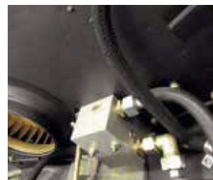
Beim Käfer ersetzt ein Thermo-block den Original-Ölkühler
