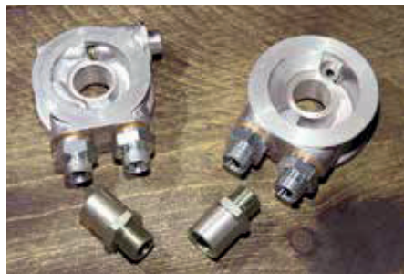
Die Sandwichadapter zum Anschluss am Ölfilteradapter gibt es mit Thermostat (l.), das ab 75 Grad öffnet, oder auch ohne. Zur Befestigung dient eine Hohlschraube
